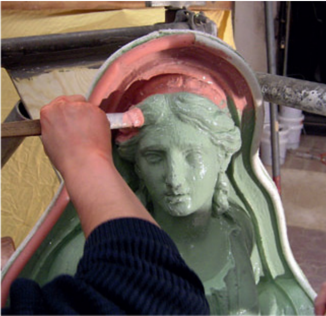
17 Kolmannen silikonikerroksen levittäminen muotin toiseen puoliskoon
