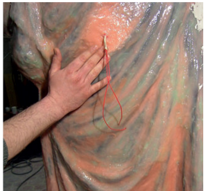
11 Aseta kiinnitysruuenkit muotin tukeen
