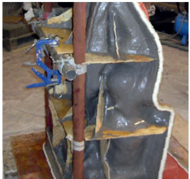
16 Muotin ensimmäisen puoliskon tukeminen ja kiinnitys
